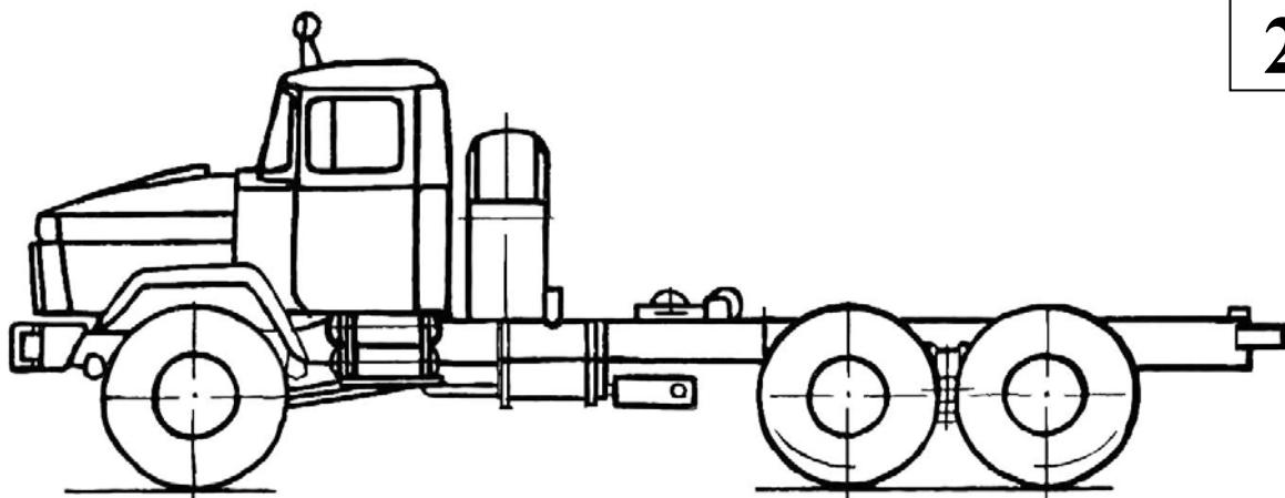
Рисунок 2 – Шасси КрАЗ-63221
